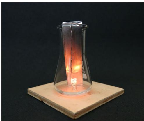
**Abb. 4:** Glühender Platindraht im Erlenmeyerkolben mit Waschbenzin.
