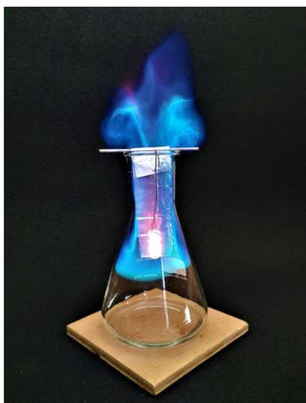
Abb. 8: Moment der Verpuffung des n-Pentans am Platindraht.
