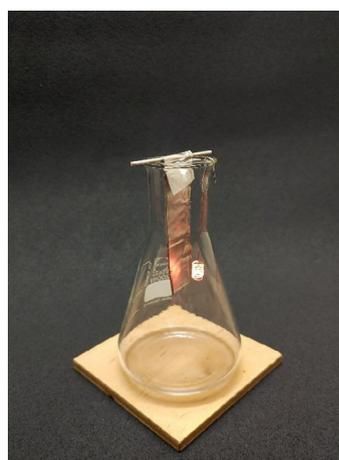
Abb. 7: Aufbau seitlich, Verpuffung von n-Pentan am Platindraht.
