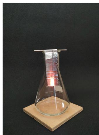
Abb. 6: Aufbau frontal, Verpuffung von n-Pentan am Platindraht.
