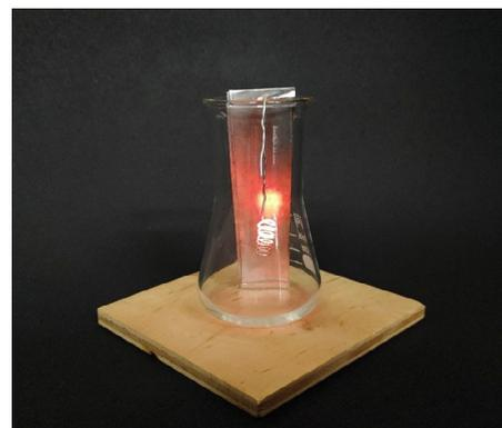
**Abb. 5:** Glühender Platindraht im Erlenmeyerkolben mit n-Hexan.
